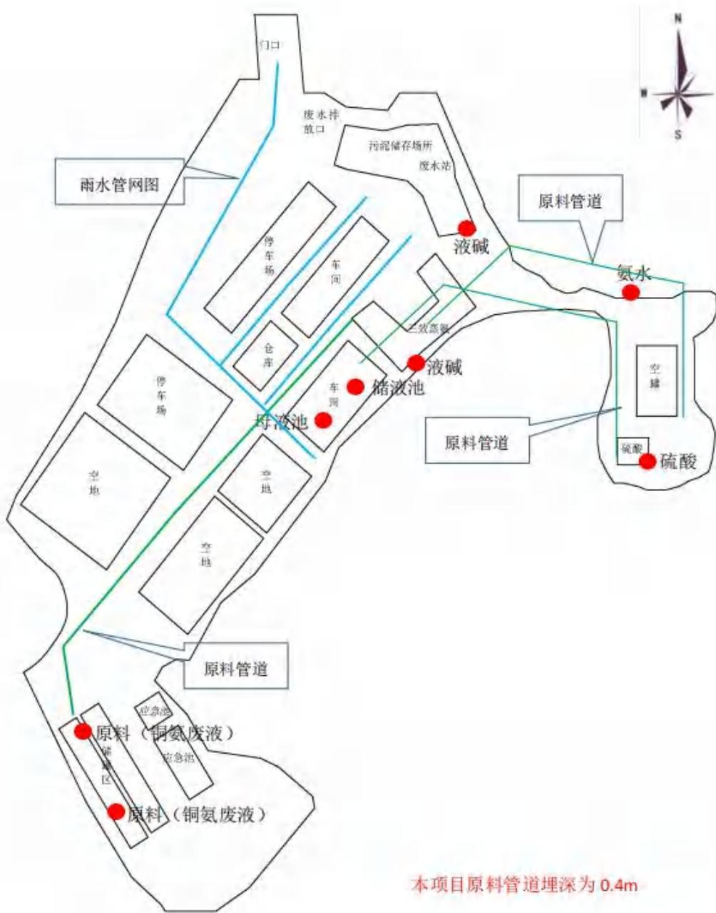
图 4-2 公司雨、原料管道管网分布图
