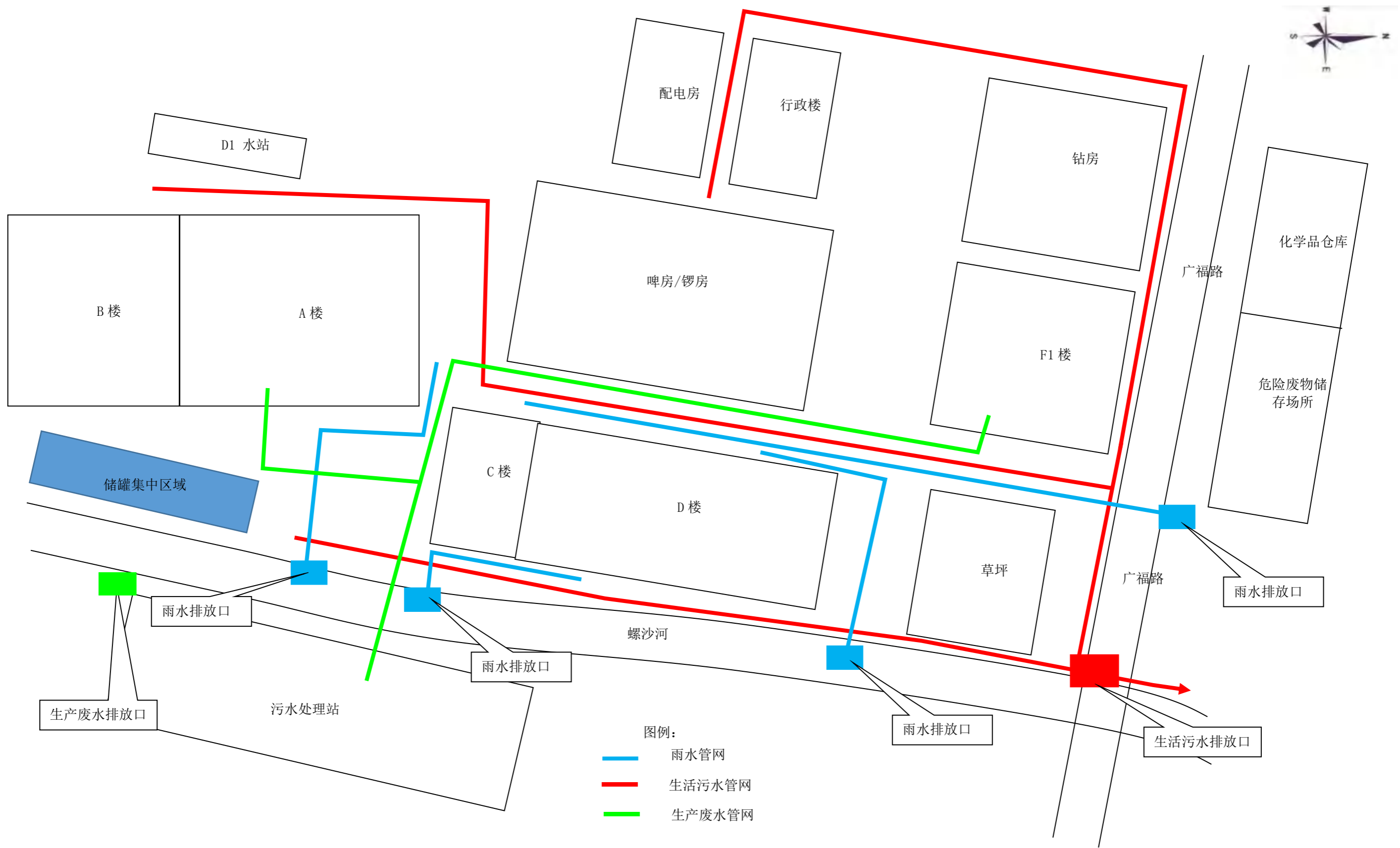
图 4-13 公司雨、原料管道管网分布
