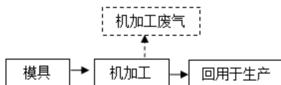
图 3 边角料加工工艺流程图
