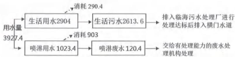
图 2.6-2 项目用水量平衡图 (t/a)
