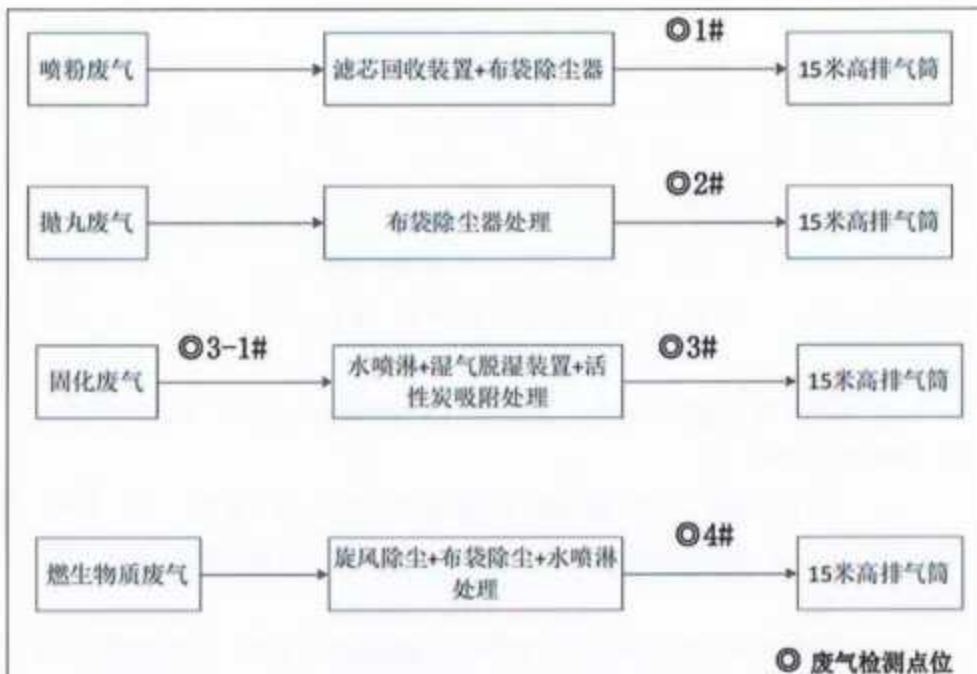
图 3-2 废气处理工艺流程图
