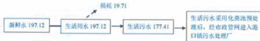
图 2-1 项目水平衡图
