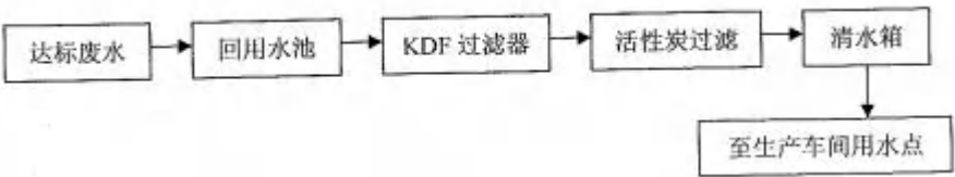
回用系统工艺流程图
