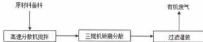
图 3.6-3 溶剂型涂料系列产品生产工艺流程
