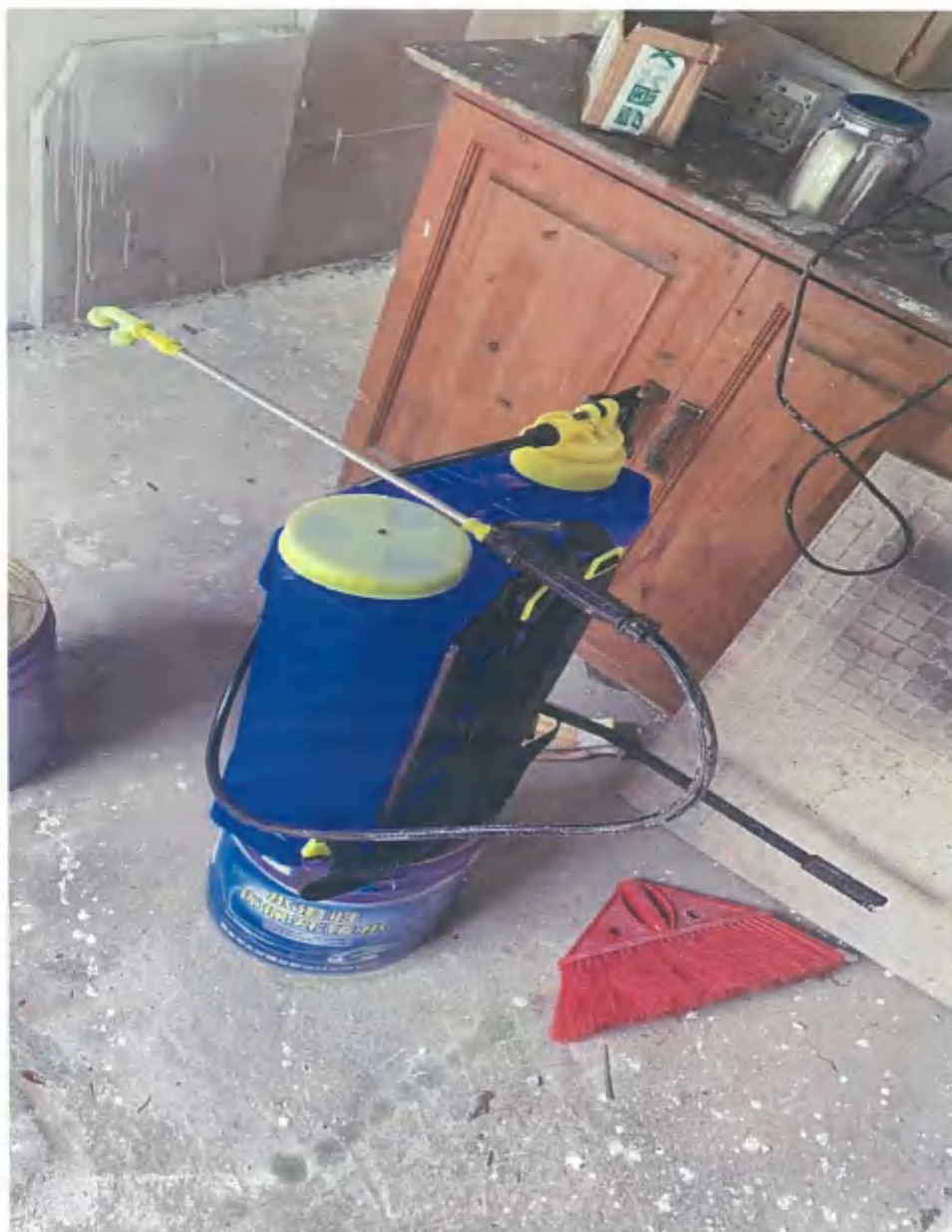
图 8-2 手动喷洒消臭、脱臭剂装置
