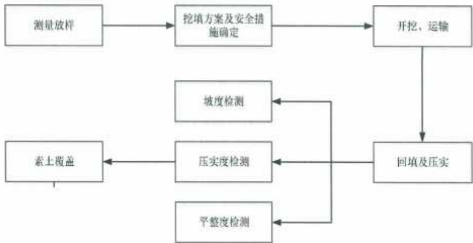
图 3-5 垃圾堆体整形工程施工流程图
