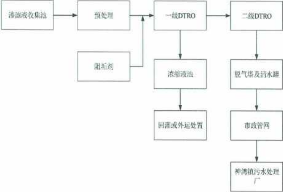
图 3-31 “预处理+两级 DTRO”处理工艺流程图
