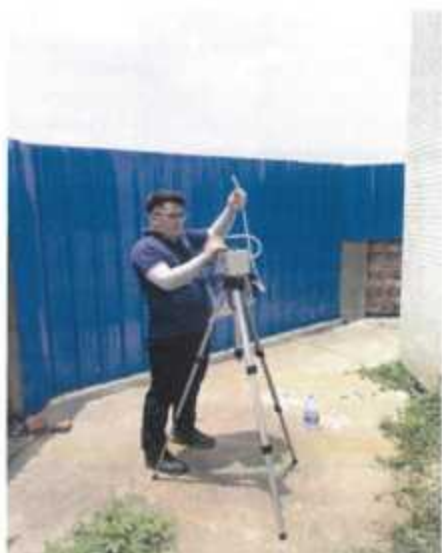
厂界废气上风向参照点 1#
