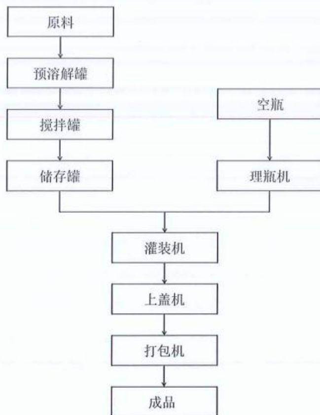
图 3-8 漱口水生产设备流程图
