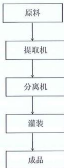
图 3-7 提取液生产工艺流程图
