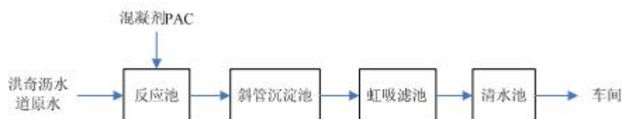
图 1 项目河水净化工艺流程图
