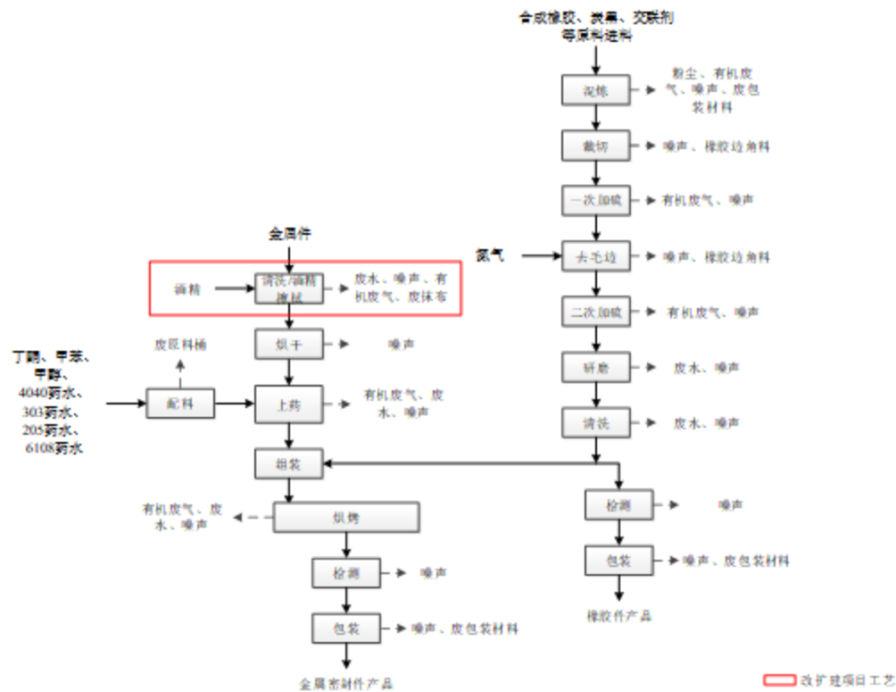
图 2-5 金属密封件生产工艺流程图
