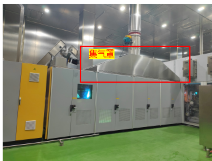
图 4-1 吹瓶废气收集方式示意图
